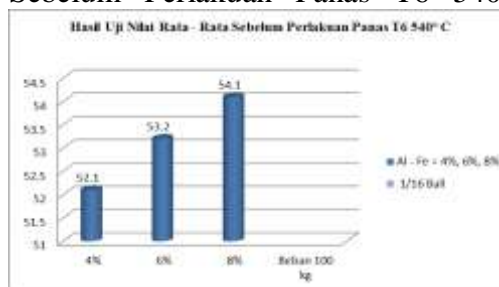
Gambar Grafik 4.1. Nilai Rata – Rata Uji Kekerasan Sebelum Perlakuan Panas T6 540°C
