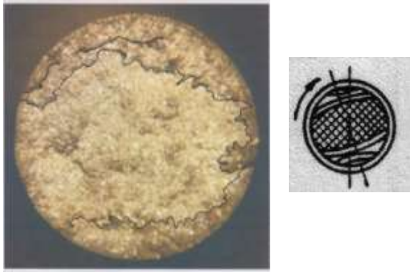
Gambar 8. Patahan uji fatik spesimen volume cairan 550ml dengan beban penekanan 100kg
