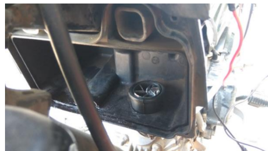
Gambar 5. Tempat Pemasangan Turbo Cyclone
