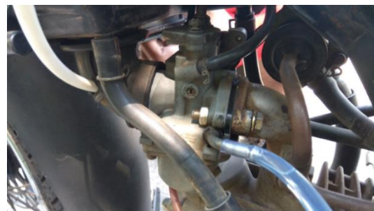
Gambar 4. Tempat Injeksi Gas HHO
