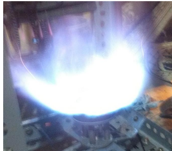
Gambar 14. Api saat tanpa selubung bukaan katup penuh
