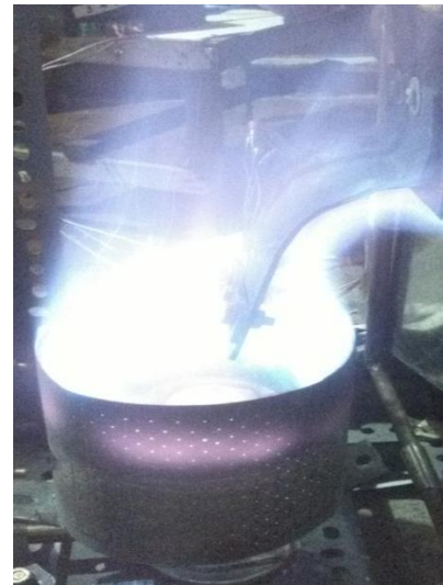
Gambar 26. Distribusi temperatur selubung 2 bukaan katup penuh
