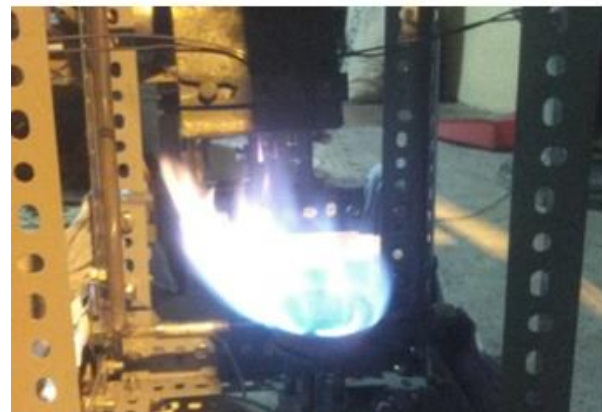
Gambar 10. Api saat tanpa selubung bukaan katup ½
