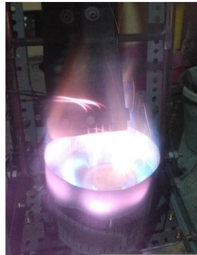
Gambar 18. Api saat selubung 1 bukaan katup \frac{3}{4}
