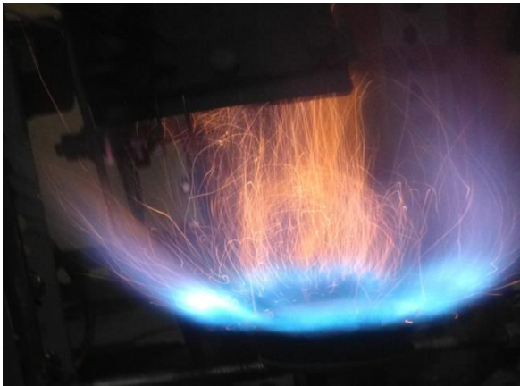
Gambar 12. Api saat tanpa selubung bukaan katup \frac{3}{4}
