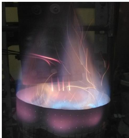
Gambar 16. Api saat selubung 1 bukaan katup \frac{1}{2}
