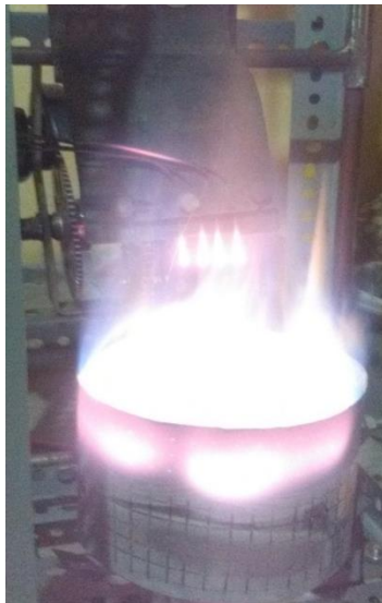
Gambar 21. Api saat selubung 1 bukaan katup penuh
