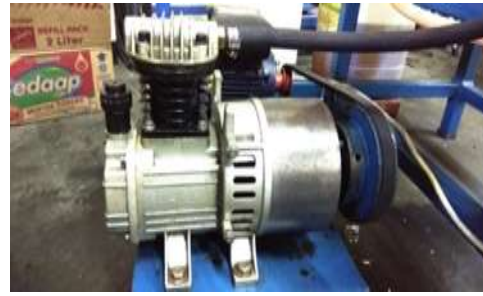
Gambar 5 Kompresor yang telah di modifikasi
