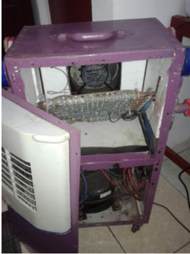
Gambar Skema Pengamatan Pipa Kapiler Pada Dispenser
