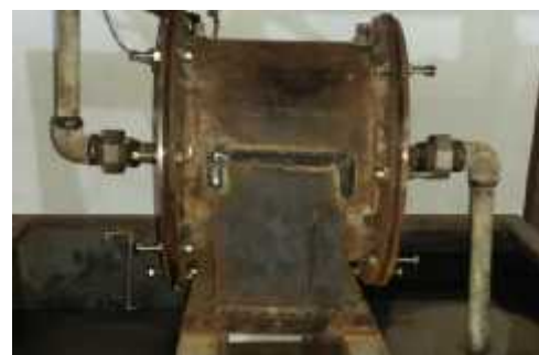
Gambar 12. Sketsa tabung subcooling dan hasil jadi pembuatan subcooling
