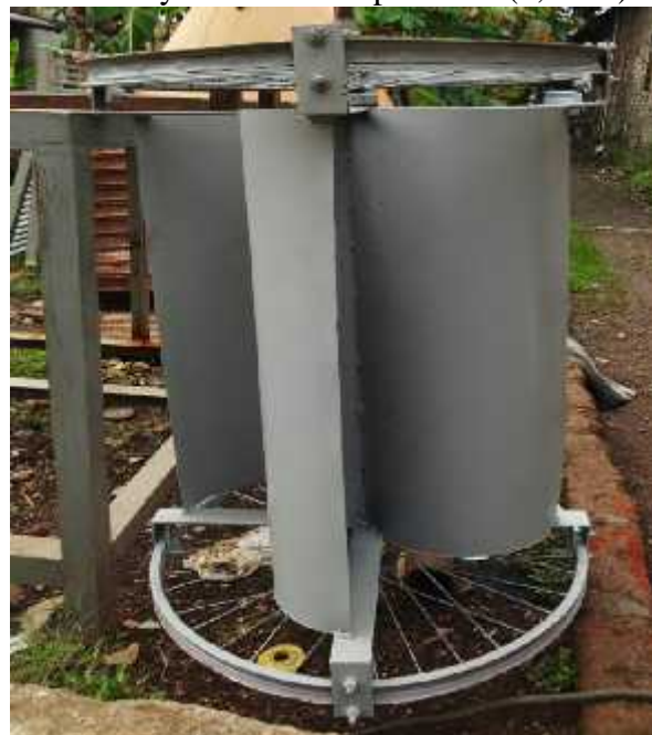
Gambar 3. Plat sudu yang sudah di Roll
