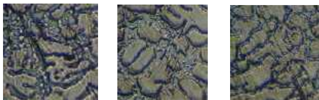
Gambar 9 (a) Foto spesimen uji temperatur penguangan 600 °C (b) Foto spesimen uji temperatur penguangan 650 °C (c) Foto spesimen uji temperatur penguangan 700 °C dengan temperatur suhu kamar posisi A'
